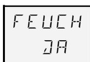
Abb. 22: Ansicht "Einstellungen Lüfter" – Option "Lüfter EIN bei Feuchte"
