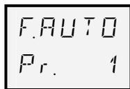
Abb. 27: Ansicht "Farblicht Automatik" – Option "Farbprogramm-Nr."
