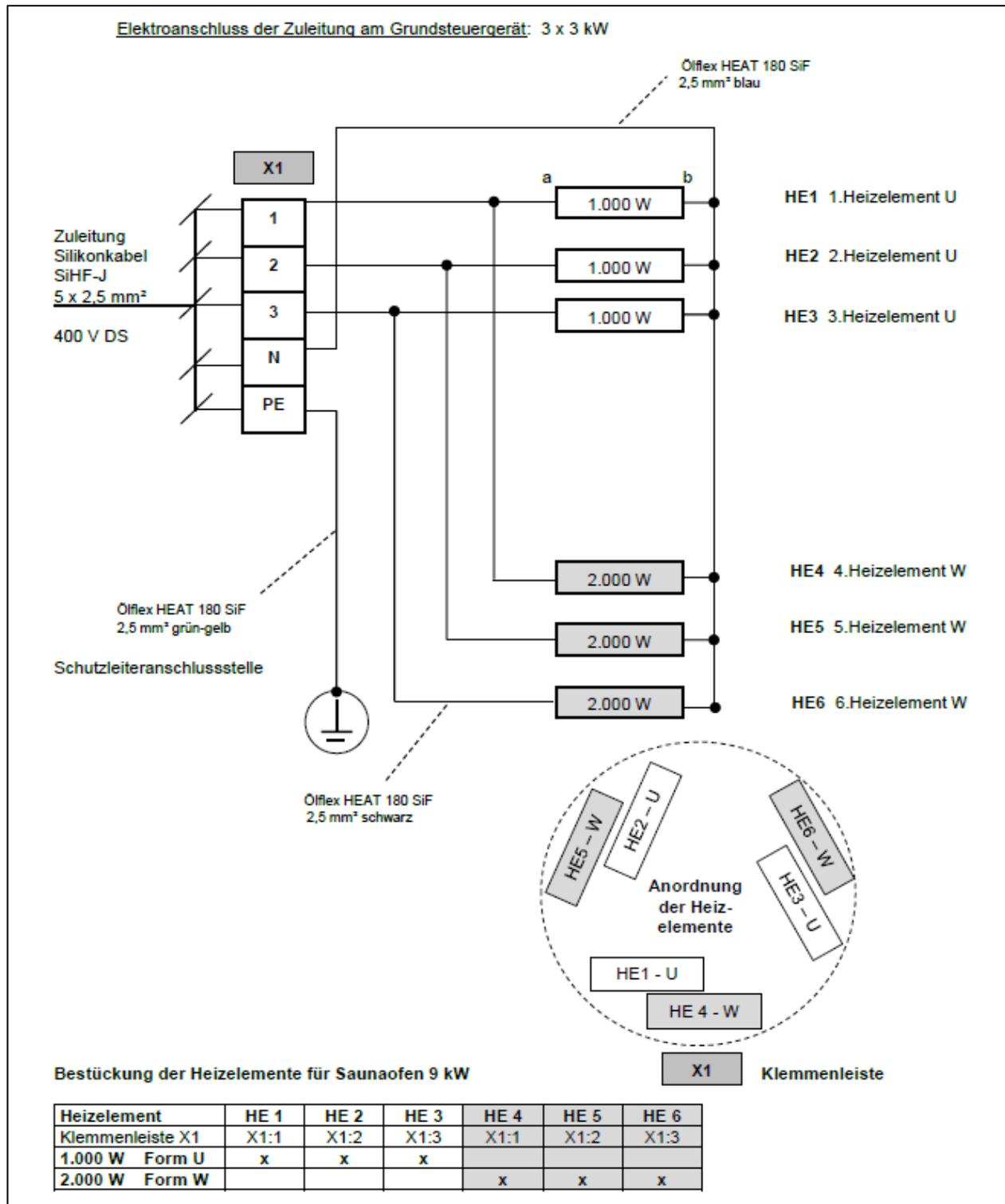
Abbildung 1: Anschlussplan 9 kW
