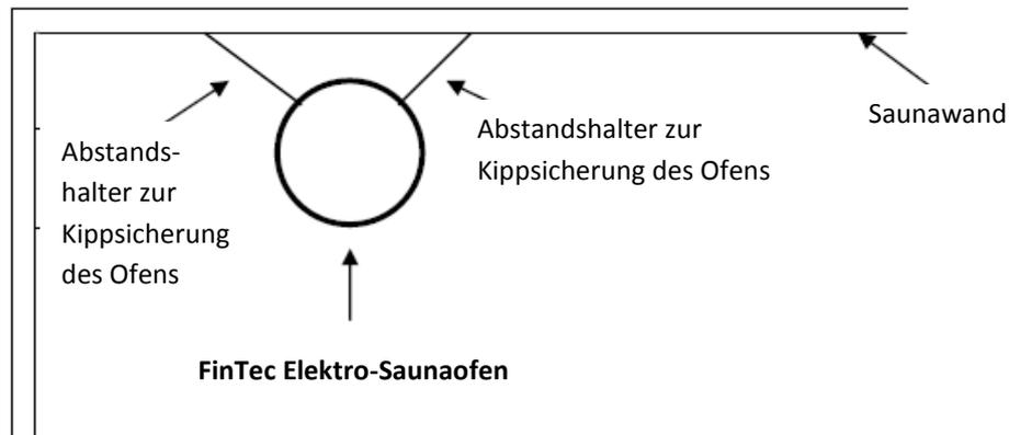
Achten Sie darauf, dass die vorgeschriebenen Sicherheitsabstände unbedingt eingehalten werden. Belüftung der Sauna Eine ausreichende Belüftung des Saunaraumes ist unerlässlich.
