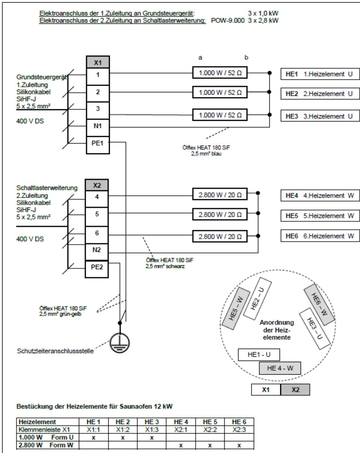
Abbildung 2: Schaltplan 12 kW
