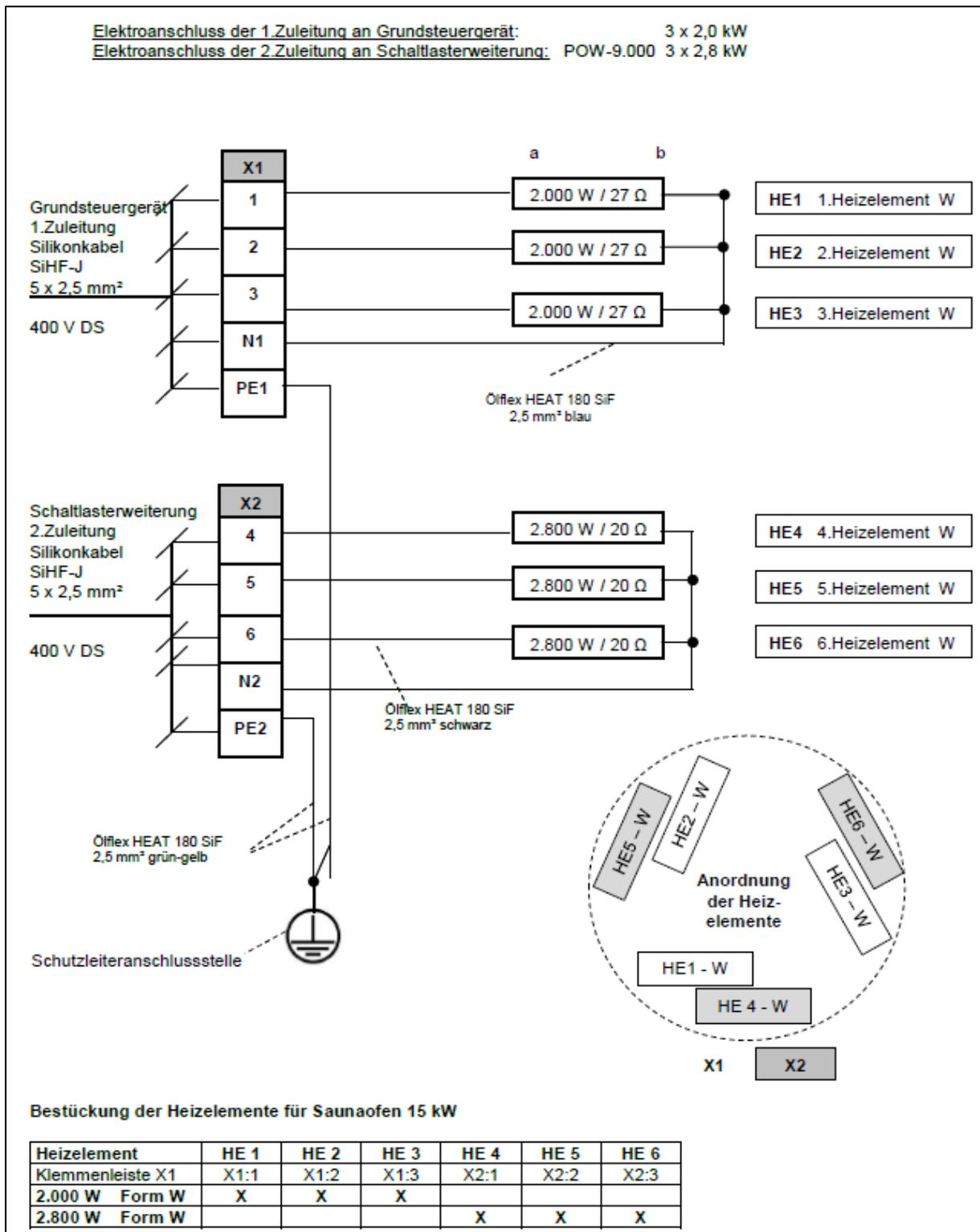
Abbildung 3: Anschlussplan 15 kW
