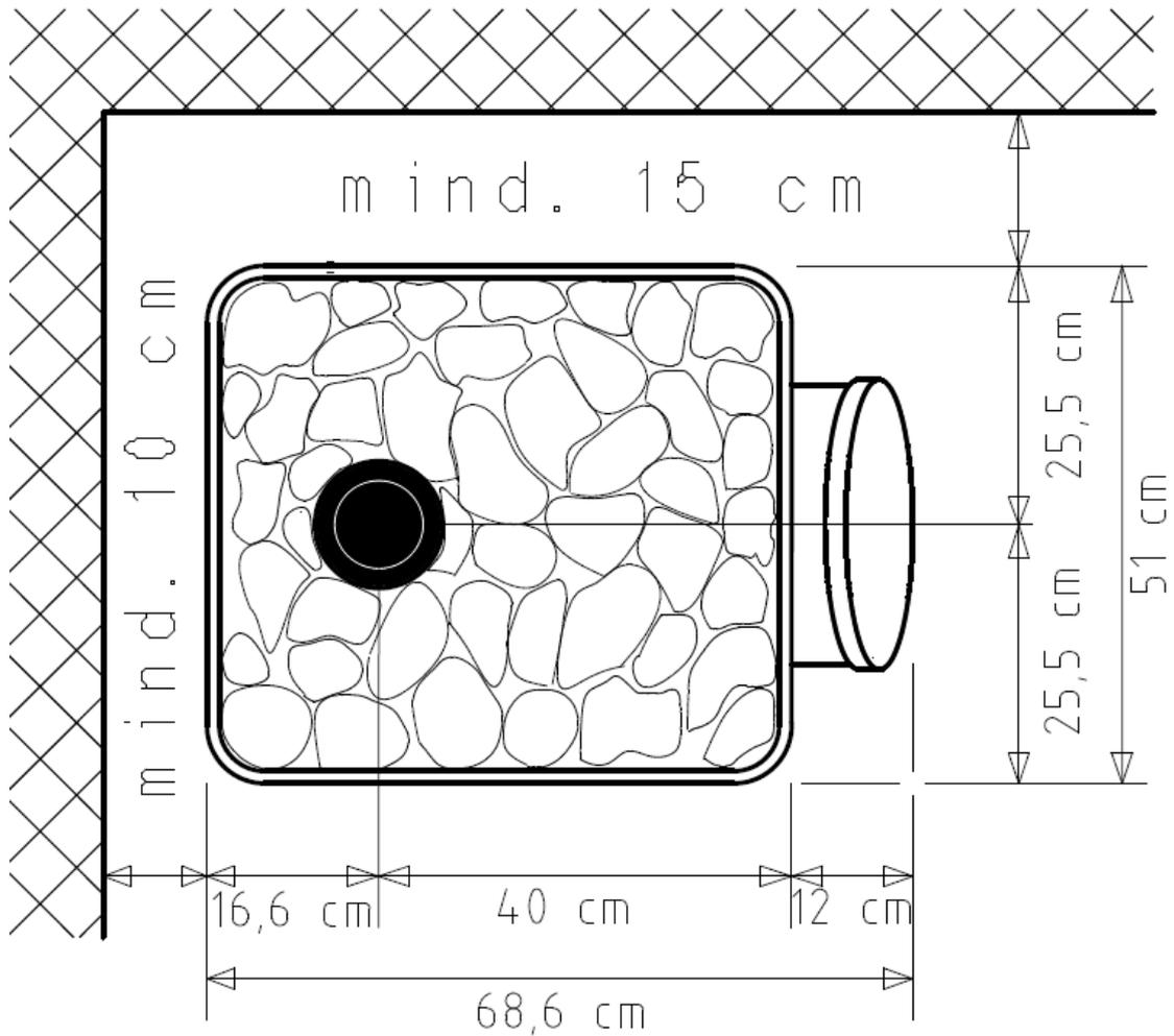
Abbildung 1: Abmessungen und seitliche Sicherheitsabstände
