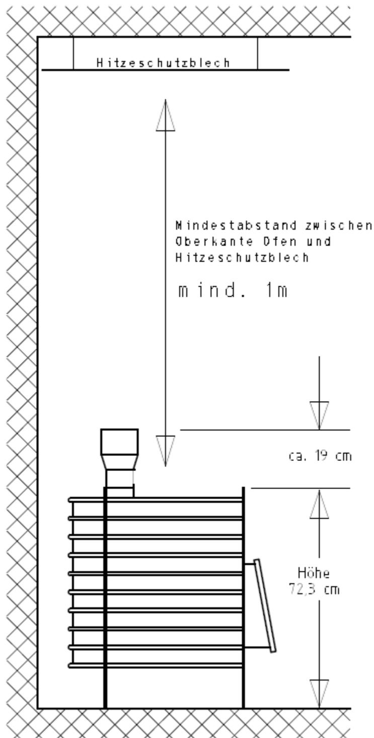
Abbildung 2: Abmessungen und Sicherheitsabstände zur Decke
