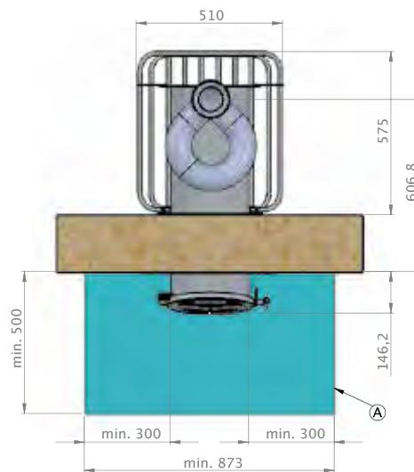
Ⓐ Schutzplatte aus nicht brennbaren Materialien, wenn der Ofen auf brennbaren Böden (z.B. Holz) installiert wird. (Mindestabmaße siehe nebenstehende Zeichnung)
