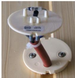
4. Signalleitung in Abhängigkeit des verwendeten Fühlers gemäß Anschlussplan Abb. 8 oder Abb. 9 an die Platine anschließen.
