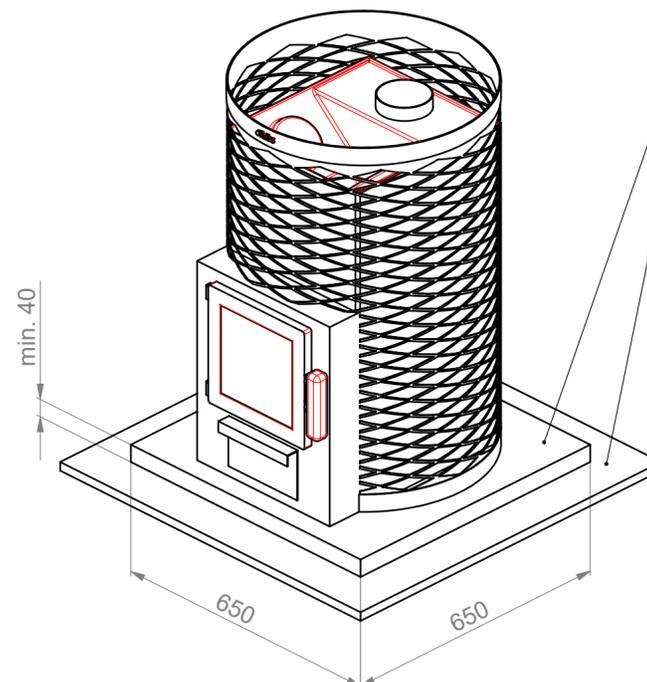
Betonplatte als Schutz für Böden aus **brennbaren** Materialien
