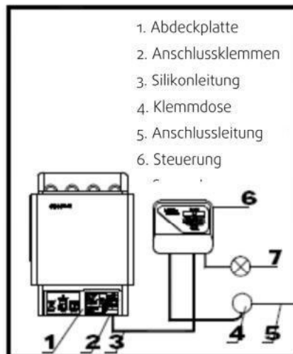
Abbildung 6.5: Anschlussplan
